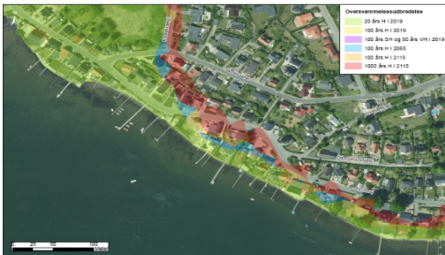
Figur 6 Udsnit af delområde Strandhuse. Allerede ved en 20 års hændelse i 2019 oplever BlueKolding problemer med forsyningsikkerheden, ligesom mange ejendomme vil opleve oversvømmelser.
