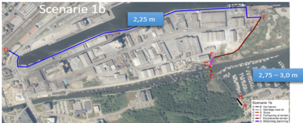
Figur 5 Sikringslinje for pumpe/slusen, som den er planlagt på nuværende tidspunkt.
