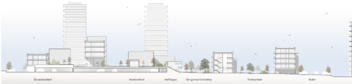
Principsnit vest-øst igennem planområdet der illustrerer den ønskede variation i udformningen af bebyggelsen (eksisterende højhusbebyggelse er vist i baggrunden)
