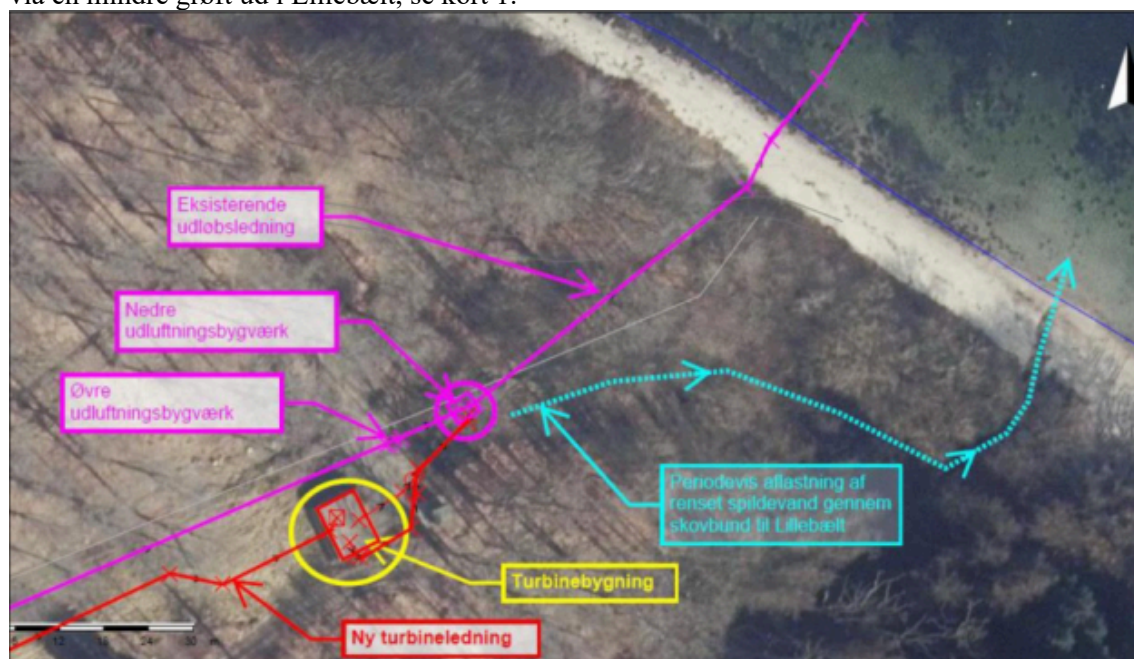
Kort 1. De eksisterende forhold ved turbinebygningen og det eksisterende udløb til Lillebælt
