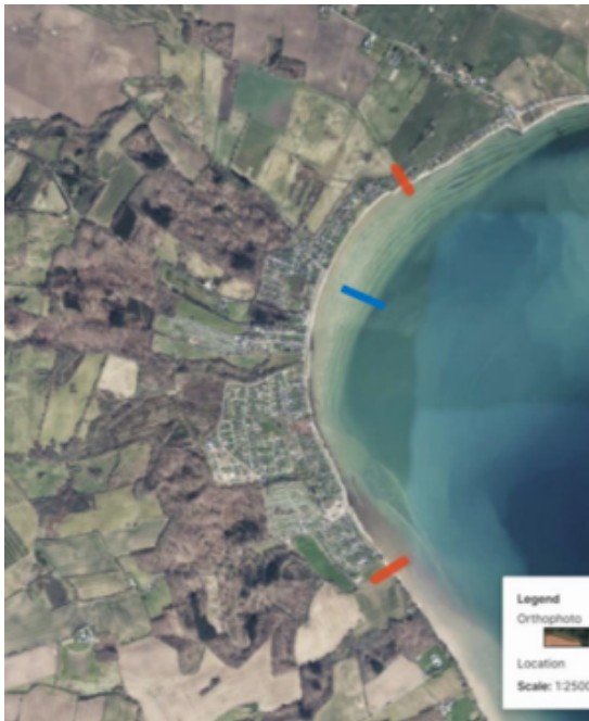
Figur 1. Hele projektområdet ses mellem de røde streger. Den blå og røde streg mod nord er det område, der beskyttes med en to-delt løsning, og mellem blå streg og rød i syd etableres der jorddige med fodring.
