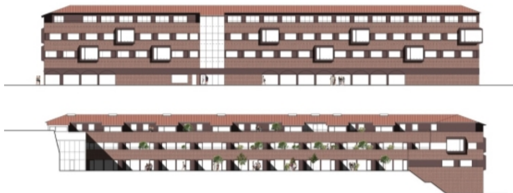
Facader mod Sydbanegade og gårdrum efter ombygning til boliger på 1. og 2. sal.
